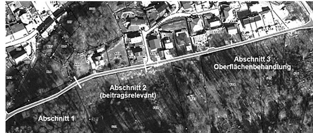
Im Abschnitt 3 ist die Strasse bereits vollständig ausgebaut. Der Deckbelag wird mittels Oberflächenbehandlung saniert. Hangseitig ist kein Randabschluss vorhanden. Da der bauliche Zustand vom restlichen Strassenoberbau ausreichend ist, wird vorerst vom Einbau eines zusätzlichen Randabschlusses abgesehen.
